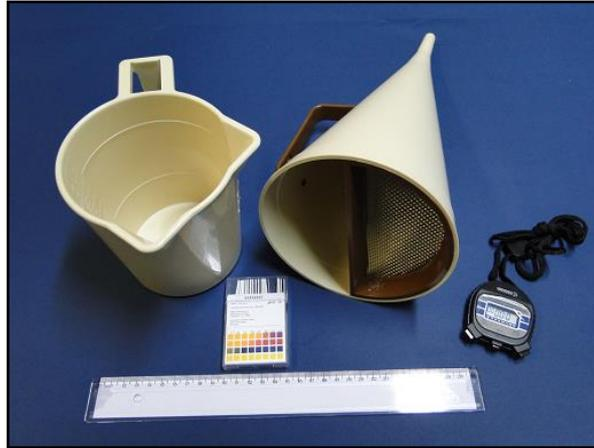
Figura 9: Kit para determinar a viscosidade de funil Marsh e o pH de fluido de perfuração.
