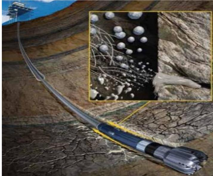
Figura 39: Material fibroso de controle de perda
