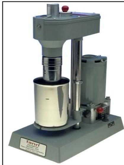
Figura 8: Viscosímetro rotativo (Fann VG Metter modelo 35 A)
