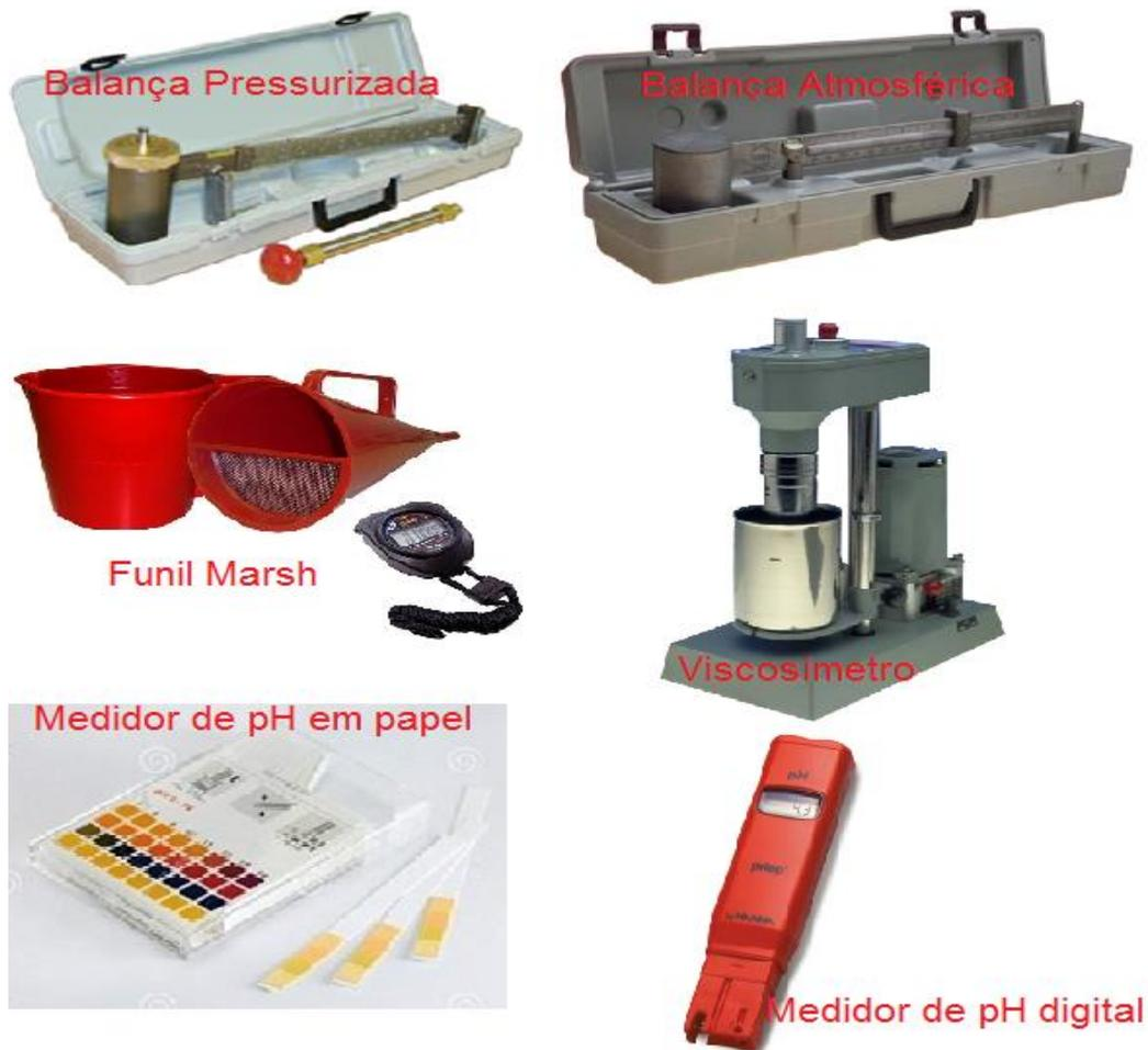
Figura 11: Medidores de densidade, viscosidade e pH (potencial de hidrogênio)
