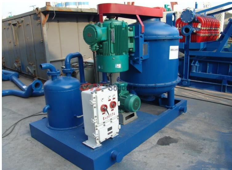
Figura 100: Desgaseificador por bomba de vácuo
