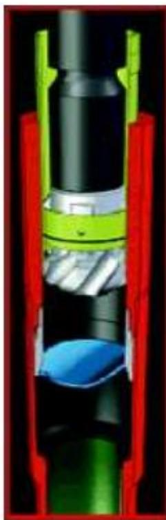
Figura 131: Detalhe de uma Casing Isolation Valve
