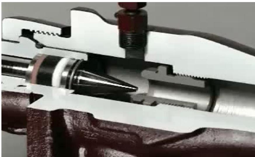
Figura 88: Choke ajustável
