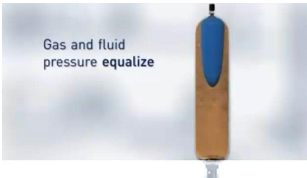
Figura 22: Garrafa acumuladora armazenando o fluido hidráulico
