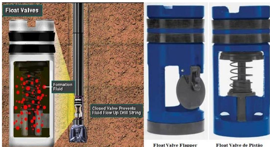
Figura 65: Float valve instalada perto da broca
