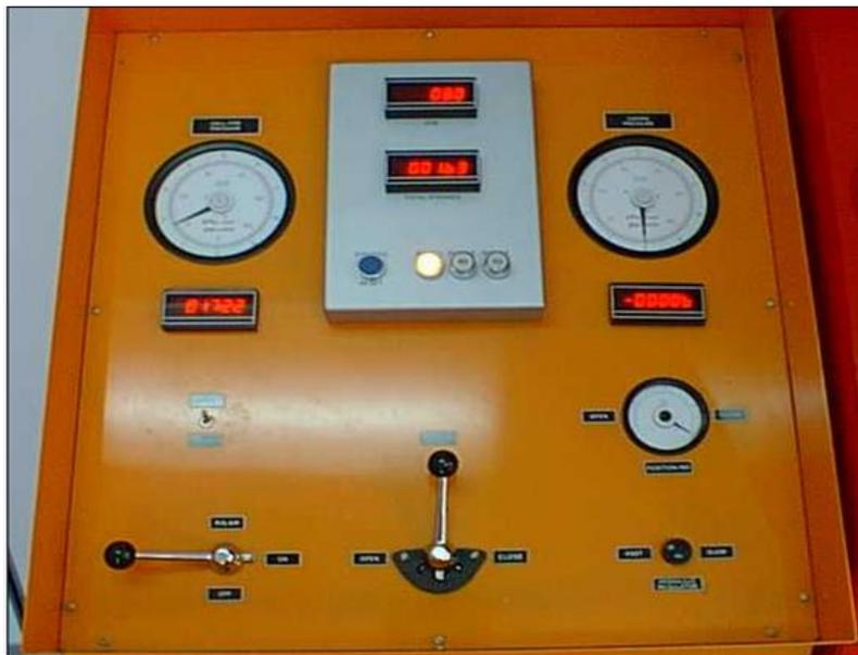
Figura 89: Painel de acionamento remoto do choke
