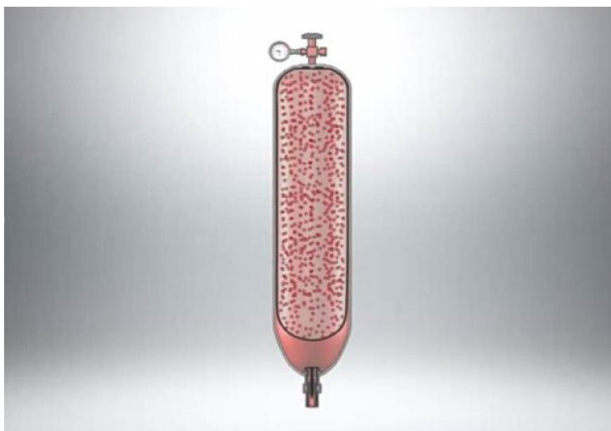
Figura 21: Garrafa acumuladora com a Pré-carga de nitrogênio
