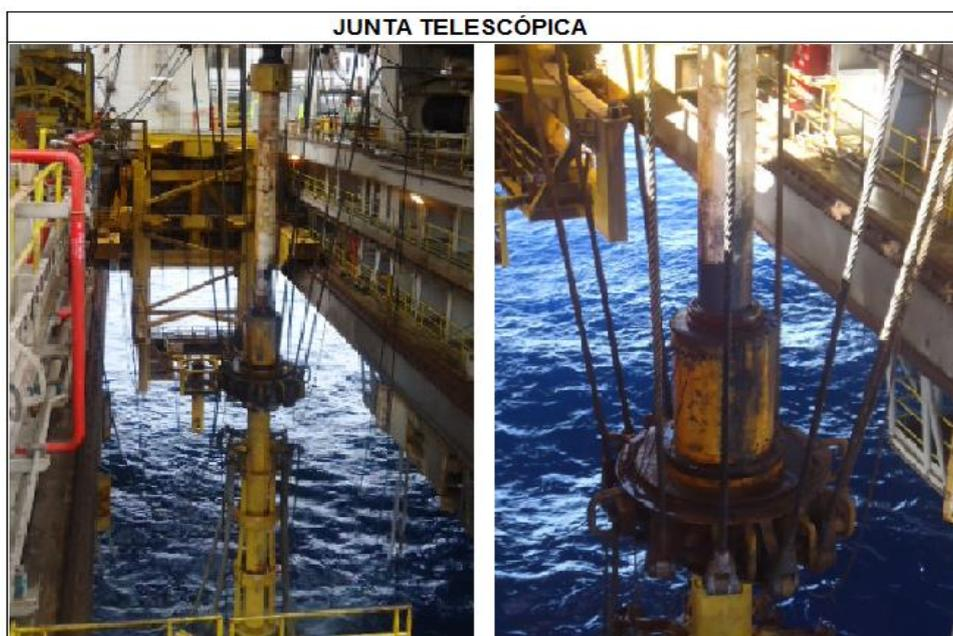
Figura 11: Junta Telescópica
