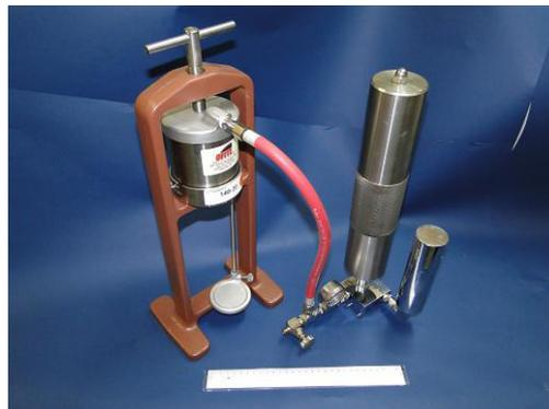
**Figura 14** - Filtro Prensa para avaliar as propriedades da torta de filtração
