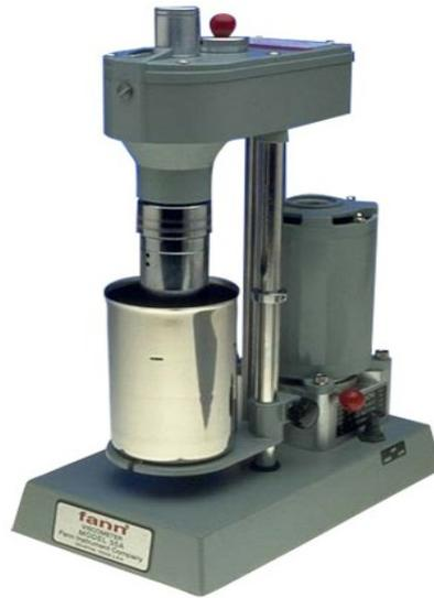
**Figura 12** - Viscosímetro rotativo (Fann VG Metter modelo 35 A)
