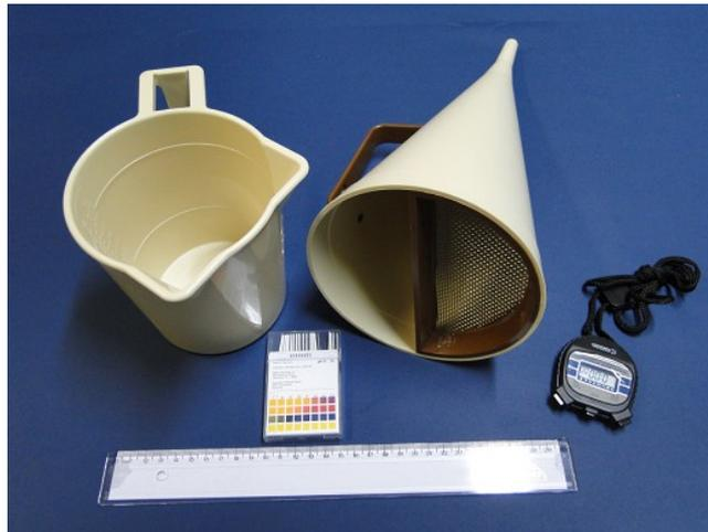
**Figura 13** - Kit para determinar a viscosidade de funil Marsh e o pH do fluido de perfuração. Copo graduado, fita de papel para determinar o pH, funil marsh e cronômetro
