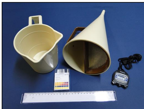
Figura 9: Kit para determinar a viscosidade de funil Marsh e o pH de fluido de perfuração.
