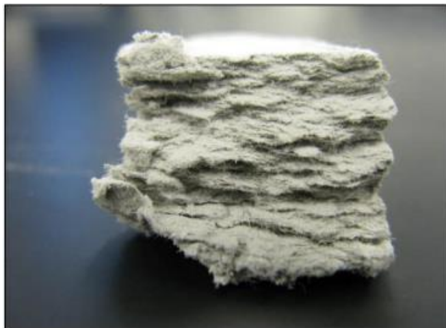
Figura 42: Tampão gerado pelo tampão de vedação devido ao alto vazamento
