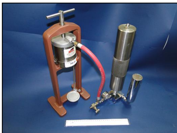
Figura 10: Filtro Prensa para avaliar as propriedades da torta de filtração
