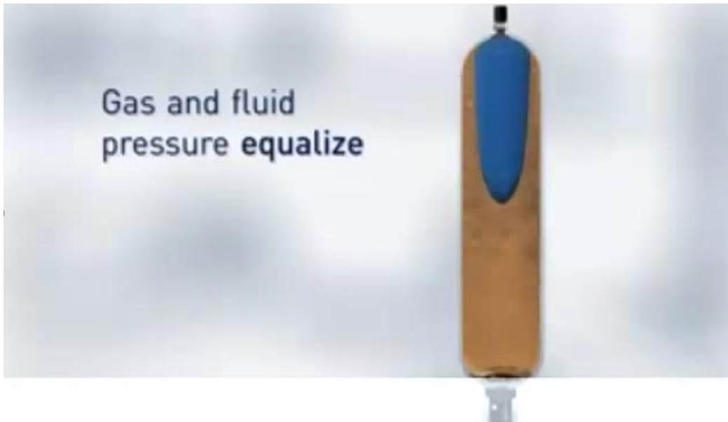
Figura 22: Garrafa acumuladora armazenando o fluido hidráulico
