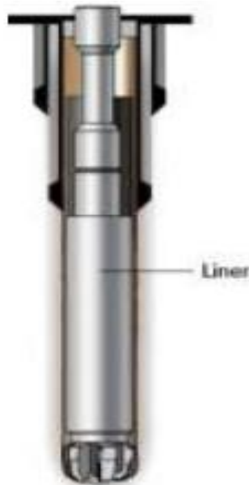
Figura 130: Perfuração com liner
