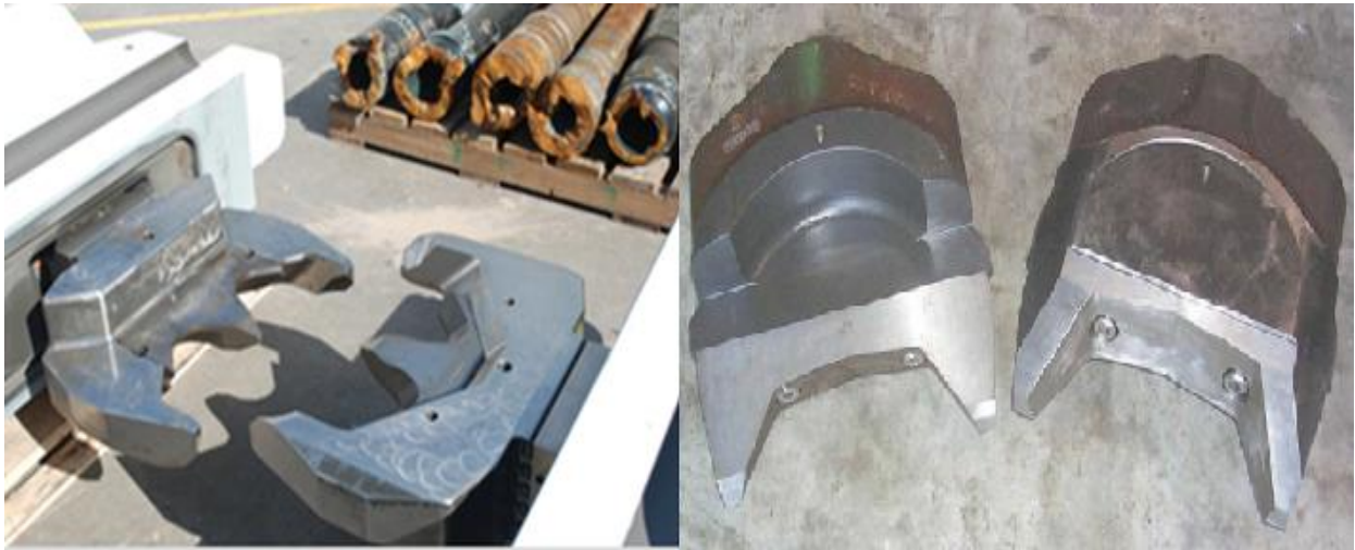
Figura 72: Gavetas cisalhantes de revestimento
