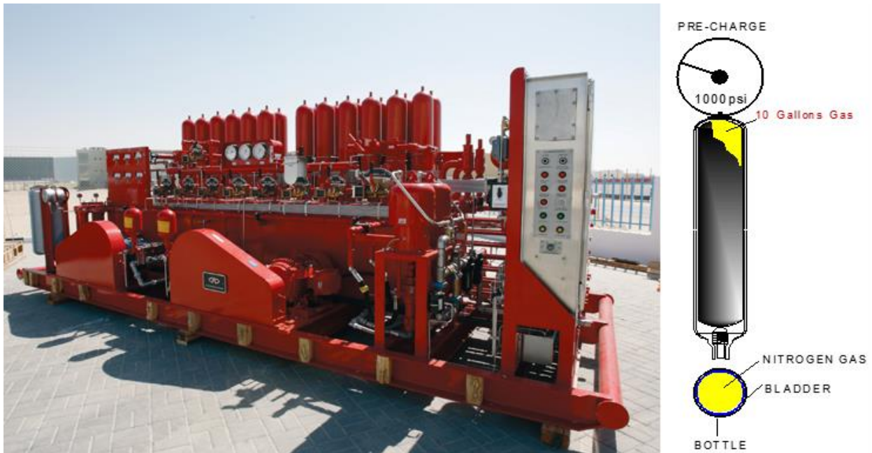
Figura 13: Banco de acumuladores
