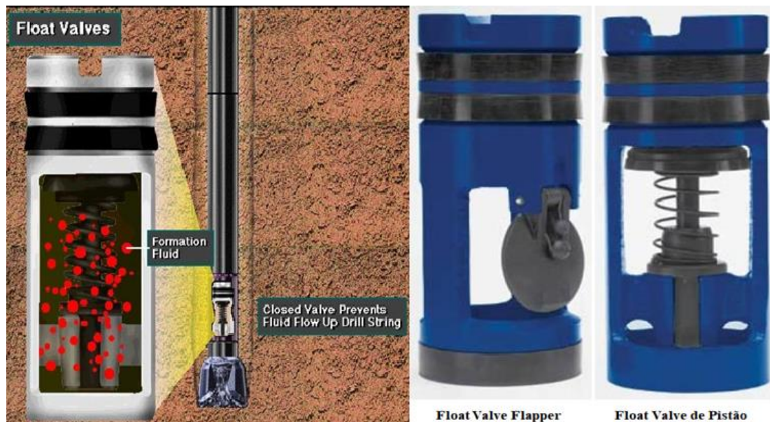
Figura 65: Float valve instalada perto da broca
