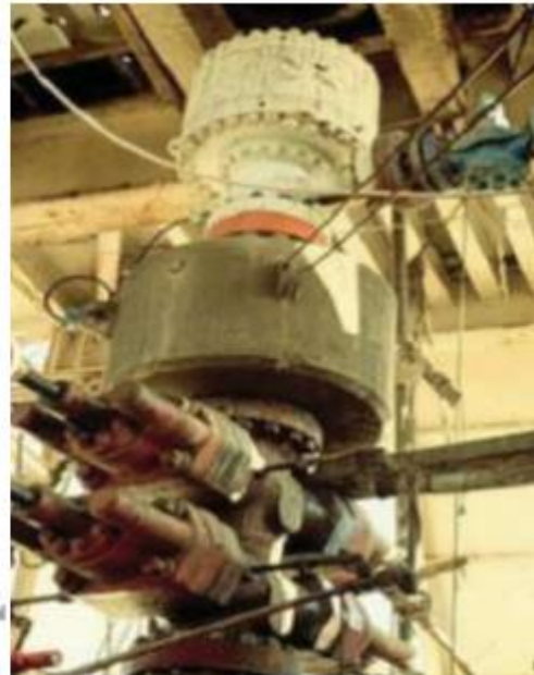
Figura 107: BOP Stack com RCD conectado
