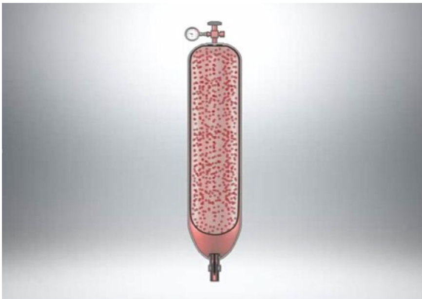
Figura 21: Garrafa acumuladora com a Pré-carga de nitrogênio
